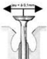
**Mesure du jeu entre tige de soupape et guide :** Avec un comparateur d'alésage et un micromètre déterminer le diamètre intérieur du guide. La valeur du jeu correspond à la différence entre le diamètre du guide et celui de la tige de soupape.
